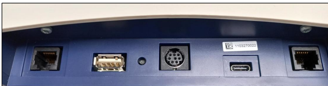
Abbildung 59 Verbindungsmöglichkeiten des Panels von links nach rechts: RJ-45 Buchse (aktuell nicht genutzt), USB-A, Fußtasten / Fußpedale, USB-C, RJ-45 (aktuell nicht genutzt)
