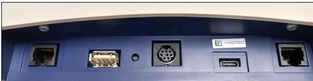
Abbildung 12 Verbindungsmöglichkeiten des Panels von links nach rechts: RJ-45 Buchse (aktuell nicht genutzt), USB-A, Fußtasten / Fußpedale, USB-C, RJ-45 (aktuell nicht genutzt)
