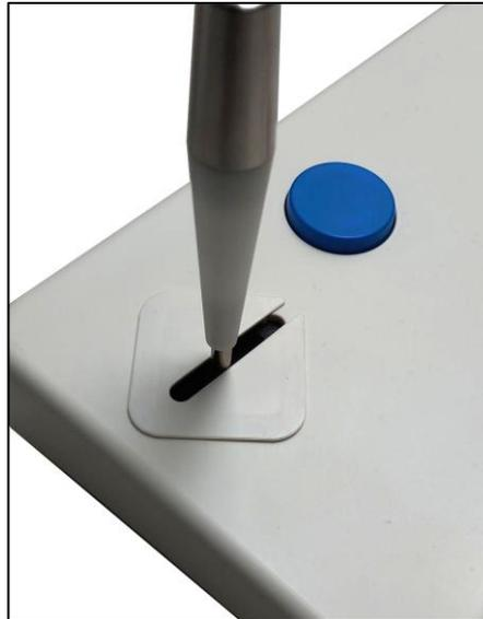
Abbildung 12 Joystickschablone auf der Probandentastatur UH montiert
