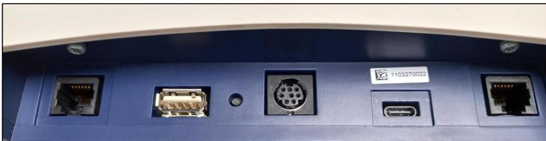
Abbildung 11 Verbindungsmöglichkeiten der Probandentastatur von links nach rechts: RJ-45 Buchse (aktuell nicht genutzt), USB-A, Fußtasten / Fußpedale, USB-C, RJ-45 (aktuell nicht genutzt)
